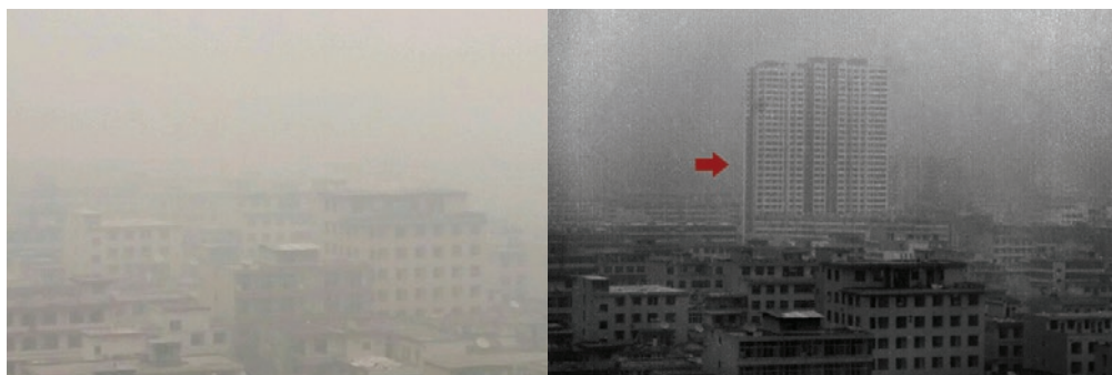
Наблюдение сквозь смог (слева – видимый спектр, справа – SWIR)
